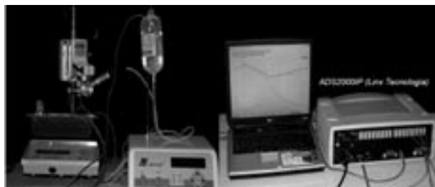
FIGURA 7– Aparato para a elaboração dos ensaios: a) aspecto geral de todo o aparato montado para os ensaios; b) sistema de aquisição de dados conectado a um computador
