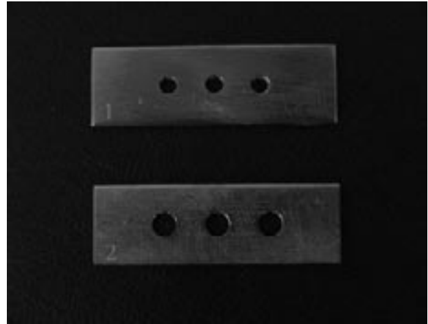
FIGURA 4 – guias metálicos utilizados nas perfurações com as brocas de 2mm (1) e de 3mm (2) de diâmetro
