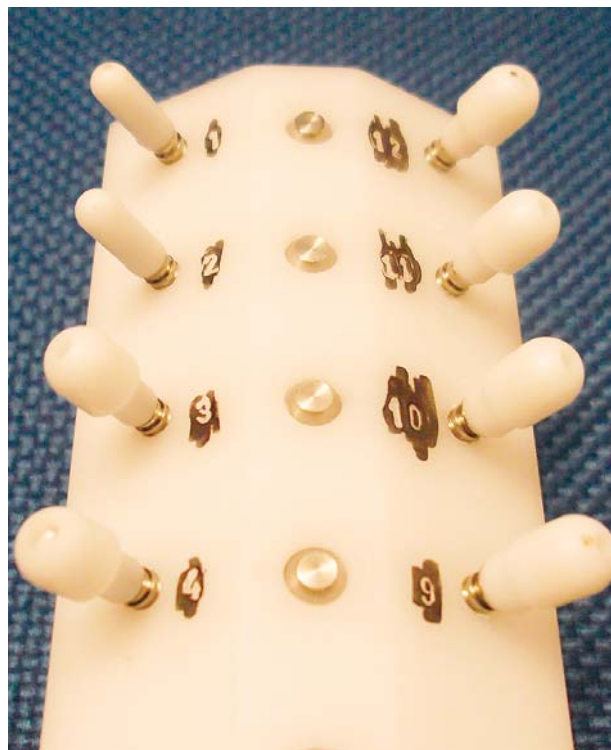
Figura 2 – Dispositivo usado nos ensaios de fadiga. A montagem foi realizada para atender as recomendações da norma técnica ISO 14801:2003. Pôde-se observar a inclinação em 30 graus dos parafusos corticais fixados no bloco de poliacetal.
